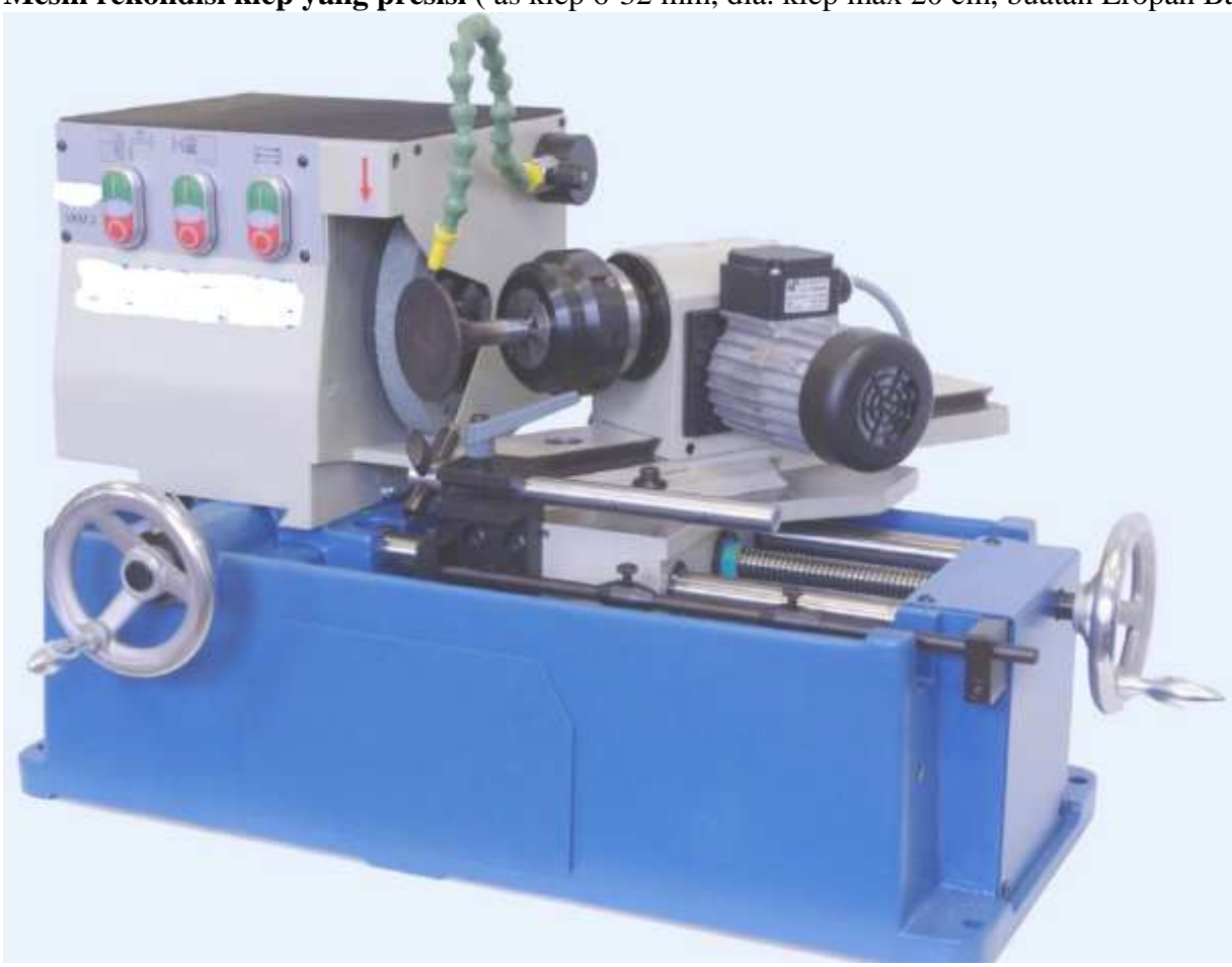
Mesin rekondisi klep yang presisi ( as klep 6-32 mm, dia. klep max 20 cm, buatan Eropah Barat )
